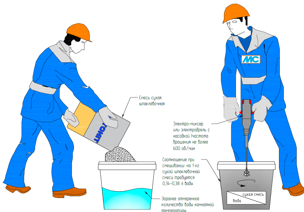
Рис. 26. Организация работ по затворению сухой шпаклевочной смеси
